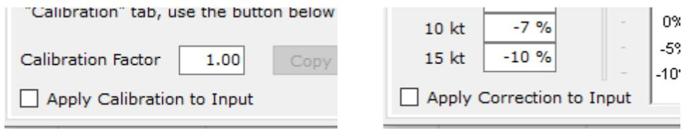
Estos factores NUNCA deben estar activados, ya que es el Procesador H5000, o Hércules, quien realiza las correcciones al sensor y aplica los ajustes de linealidad (Heel Correction). EVOLUTION asume que la velocidad que recibe es la del instrumental y no necesita ajustes adicionales.
